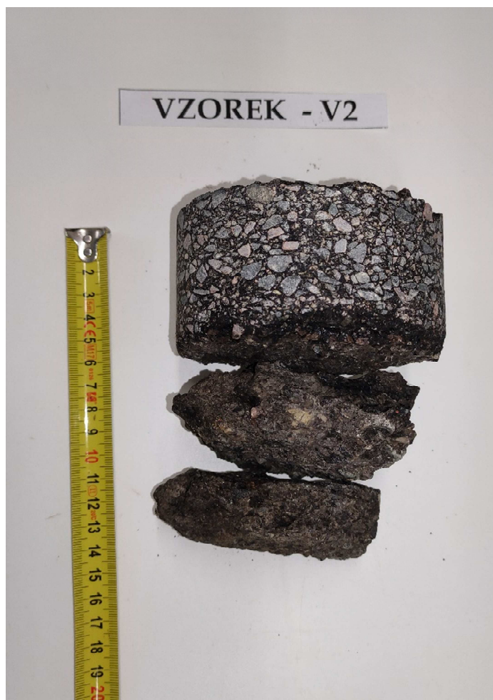
Obr. 4 - Jádru vývrtu Vzorek – V2 (laboratoř).
