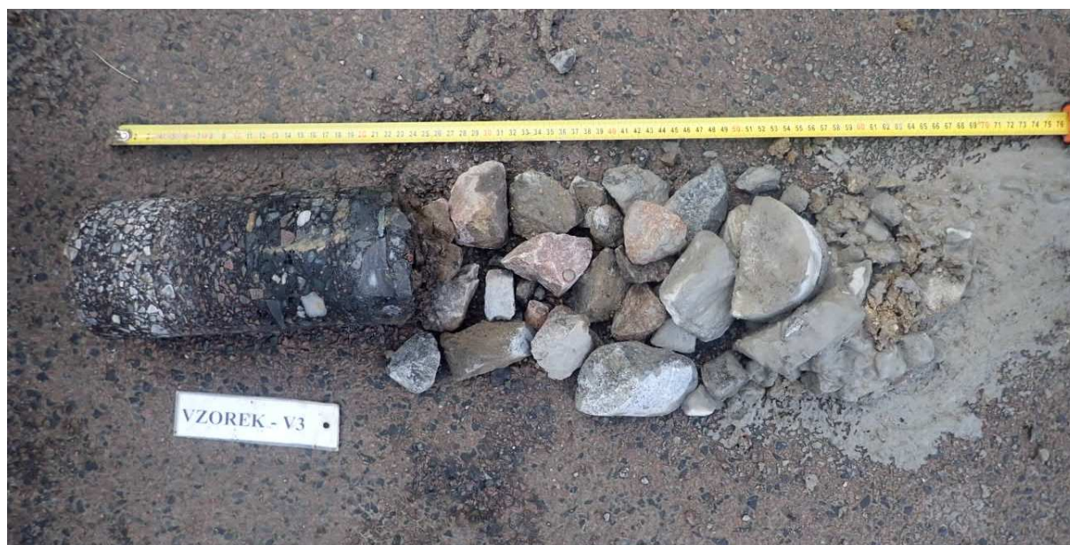
Obr. 5 - Jádru vývrtu Vzorek – V3 (in situ).
