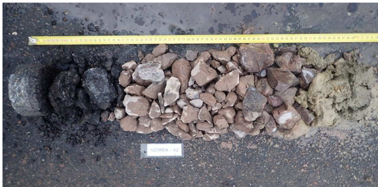
Obr. 3 - Jádro vývrtu Vzorek – V2 (in situ).
