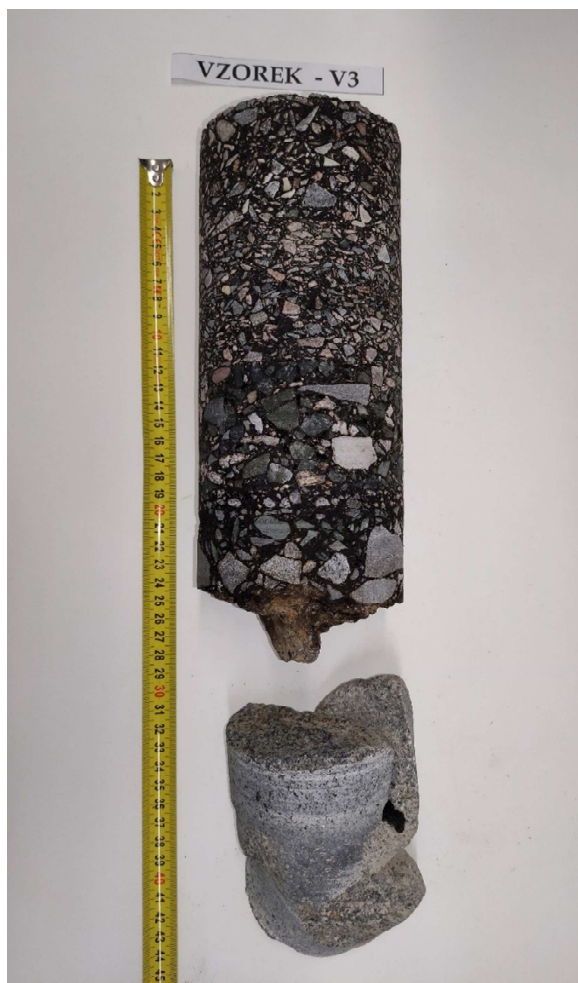
Obr. 6 - Jádru vývrtu Vzorek – V3 (laboratoř).
